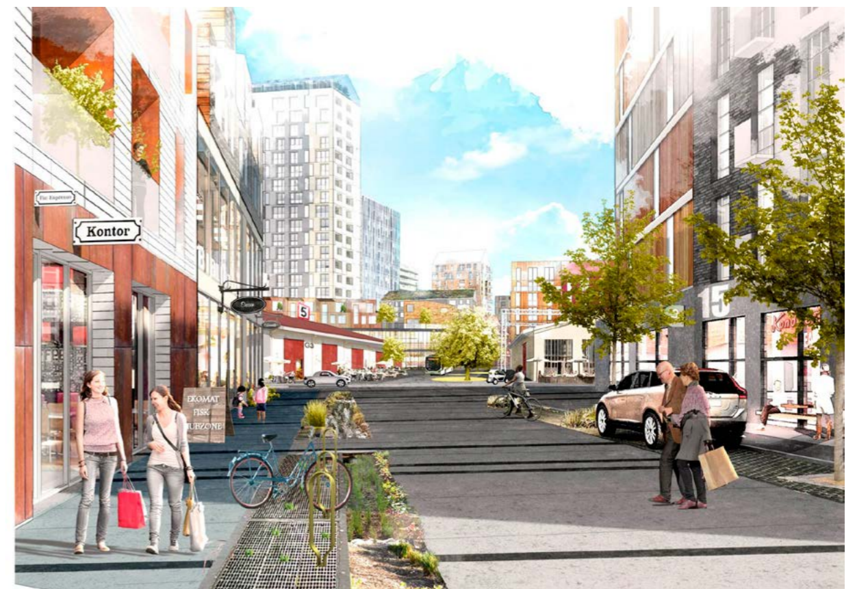
Ett exempel på samnyttjande i täta stadsrum är Frihamnen där dagvattnet föreslås hanteras i öppna lösningar tillsammans med växtlighet. Här är en exempelillustration från hållbarhetsprogrammet för Frihamnen där en dagvattenränna kombineras med cykelparkering och grönska.
