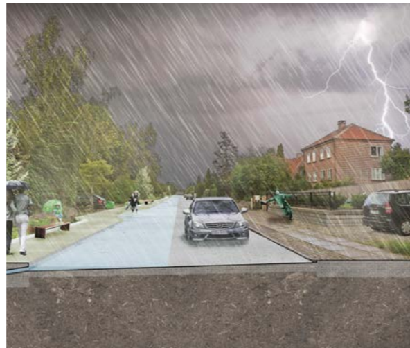
Exempel på körbana som tillåts översvämmas. (Foto: Rambøll/Atelier Dreiseitl, 2013).
