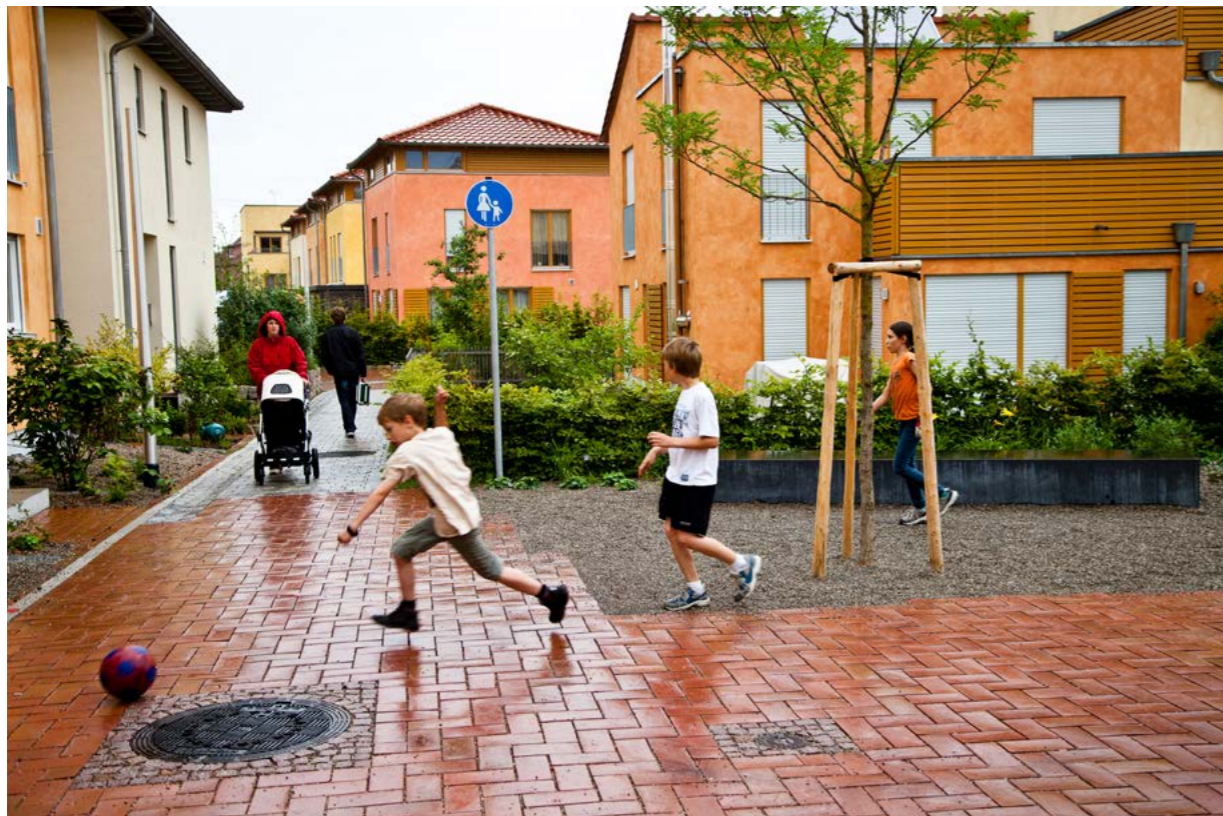
Beläggning med genomsläppliga fogar (Foto: Dreitseitl/Ramböll).
