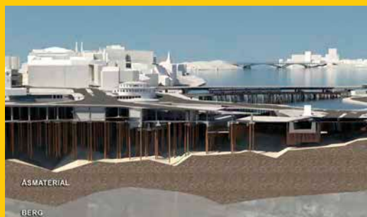
Befintlig grundläggning i 3D.
